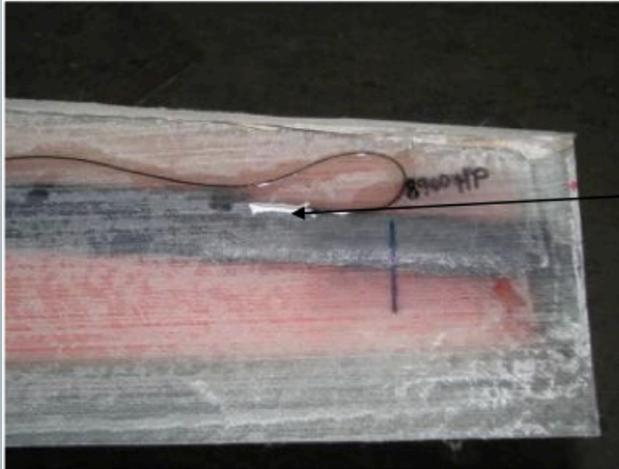
校正済み光温度センサーos4300をブレードの先端部に取付
